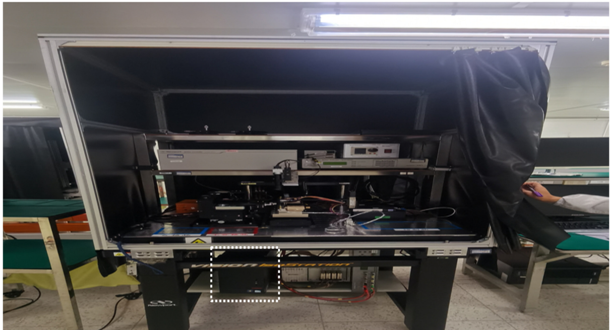
Figura 2: Foto da máquina de processamento de dados (em destaque) em uma estação de teste para barras de chips fotônicos.
